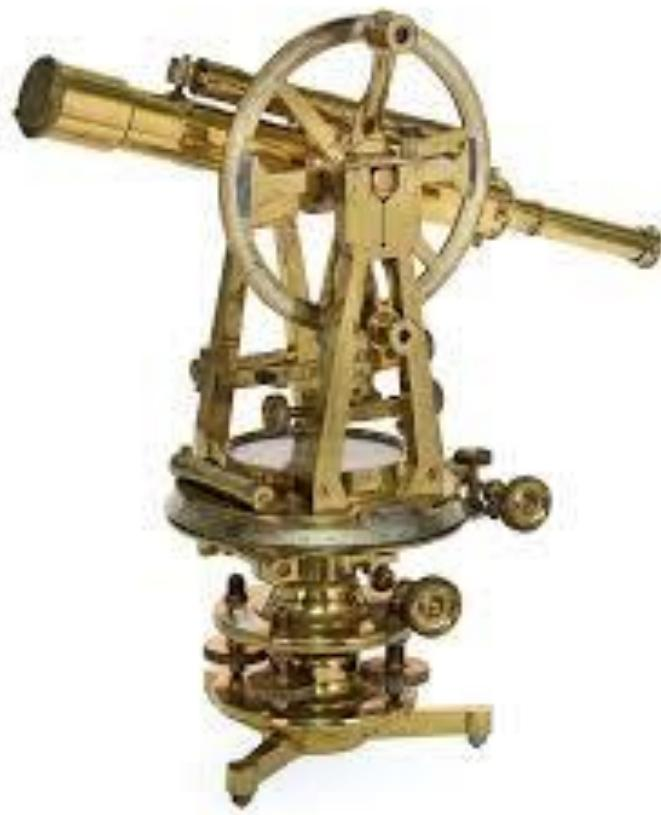
Theodolit adalah sebuah alat pengukuran yang dapat mengambil bacaan ukuran sudut dengan tepat. Kegunaan asal theodolit ialah untuk tujuan pengukuran tanah “land surveying”, namun kerana ketepatan bacaan data yang diambil menggunakan theodolit maka ia juga digunakan bagi menentukan arah kiblat dengan mengetahui latitud dan longitud tempat serta azimut matahari. Ketepatan bacaan data yang diambil menggunakan theodolit sangat tepat sehingga kepada bacaan arka saat.
